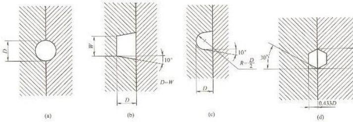
Fig.3.1 Runner profiles (a)fully round (b)trapezoidal (c)modified trapezoidal (d) hexagon
